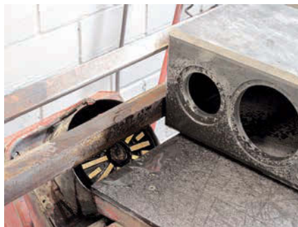
Dieser mit Diamanten besetzte Fräskopf schneidet die Kantenfase ins Gehäuse
