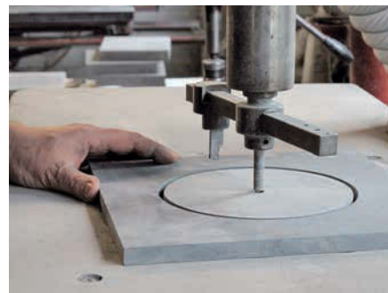
Eine Maschine schneidet die Öffnungen für Chassis und Reflexlöcher in die Schieferplatten
