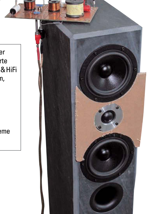
Ein Arbeitsmuster der neuen 170. Deren Weiche wird gerade abgestimmt, und die vorgesezte Blende aus Pappe simuliert eine bündige Schallwand
