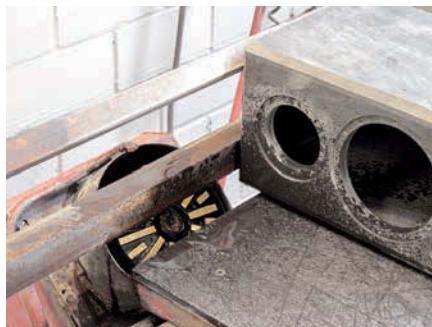
Dieser mit Diamanten besetzte Fräskopf schneidet die Kantenfase ins Gehäuse
