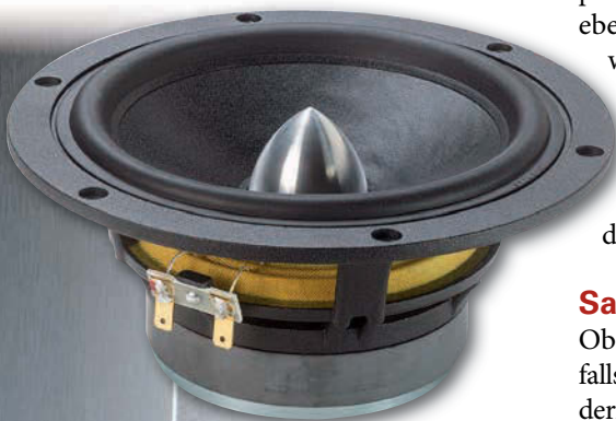
Der „Phase Plug“ im Zentrum des Tiefmitteltöners verhindert Interferenzen und Auslöschungen oberhalb der Membran
