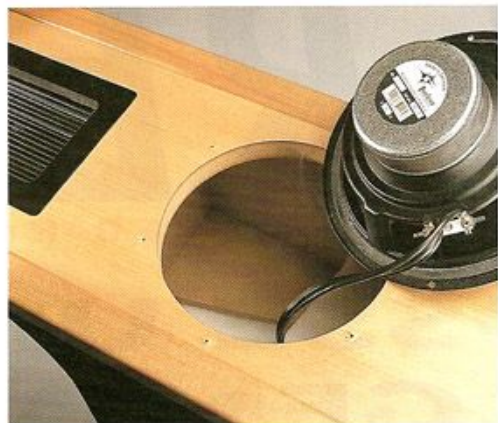
Der in einem luftdichten Gehäuse eingesetzte Tieftöner von Peerless steuert tiefreichende Bässe und warme Grundtöne bei – und fügt sich dabei dynamisch fast bruchlos zum Stator ein
